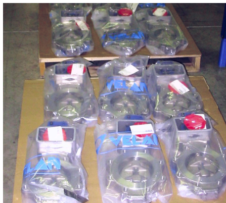
Vannes à triple excentration nettoyées à l'oxygène, prêtes à être expédiées.
