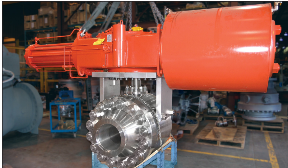
Robinet à tournant sphérique à siège métallique Securaseal NPS 18 (DN 420) classe 2500 pour conditions de service sévères pour une unité H-Oil® en Mongolie intérieure. Cette vanne est en service depuis 2008 et continue de fonctionner.
