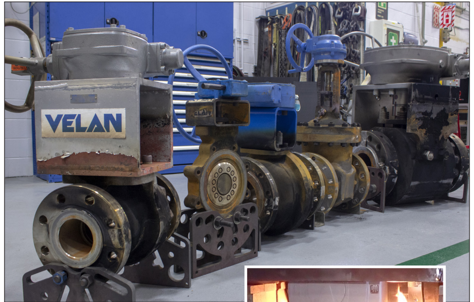
Ci-dessus : Cinq robinets Velan, dont deux robinets à tournant sphérique à siège métallique de la série R de Securaseal, ont fait l'objet d'un essai de résistance au feu selon les dernières normes API et ISO.
