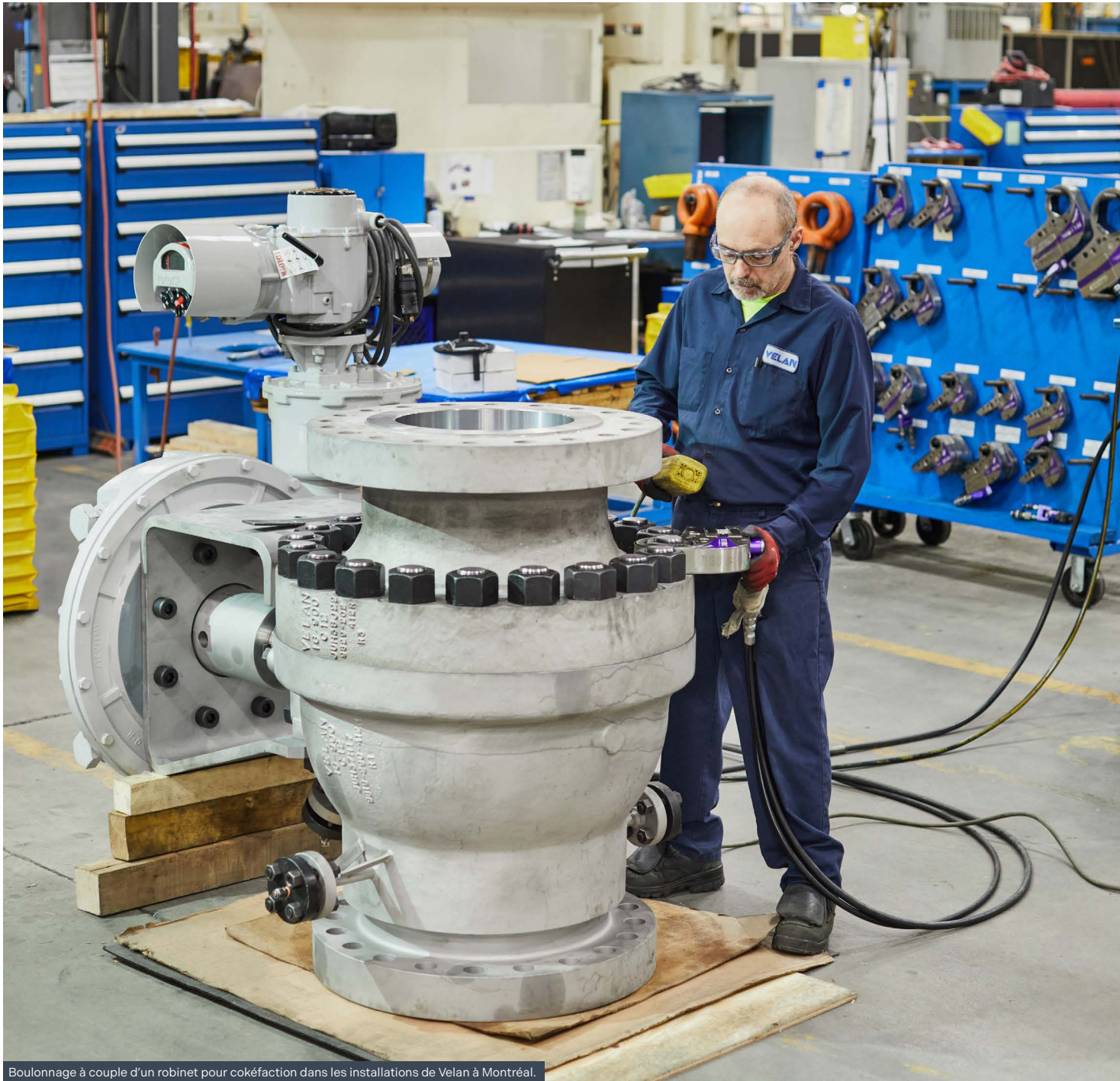
Boulonnage à couple d'un robinet pour cokéfaction dans les installations de Velan à Montréal.
