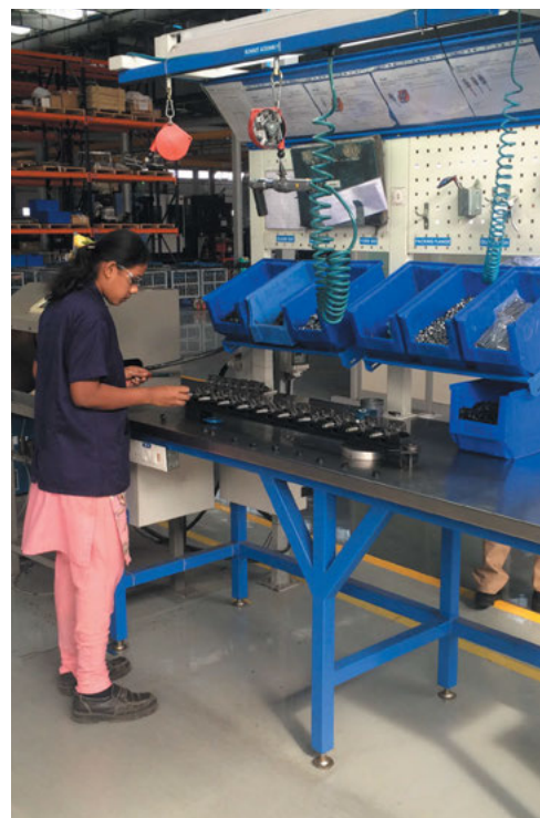
Un poste de montage des robinets forgés API 602 de petit diamètre.
