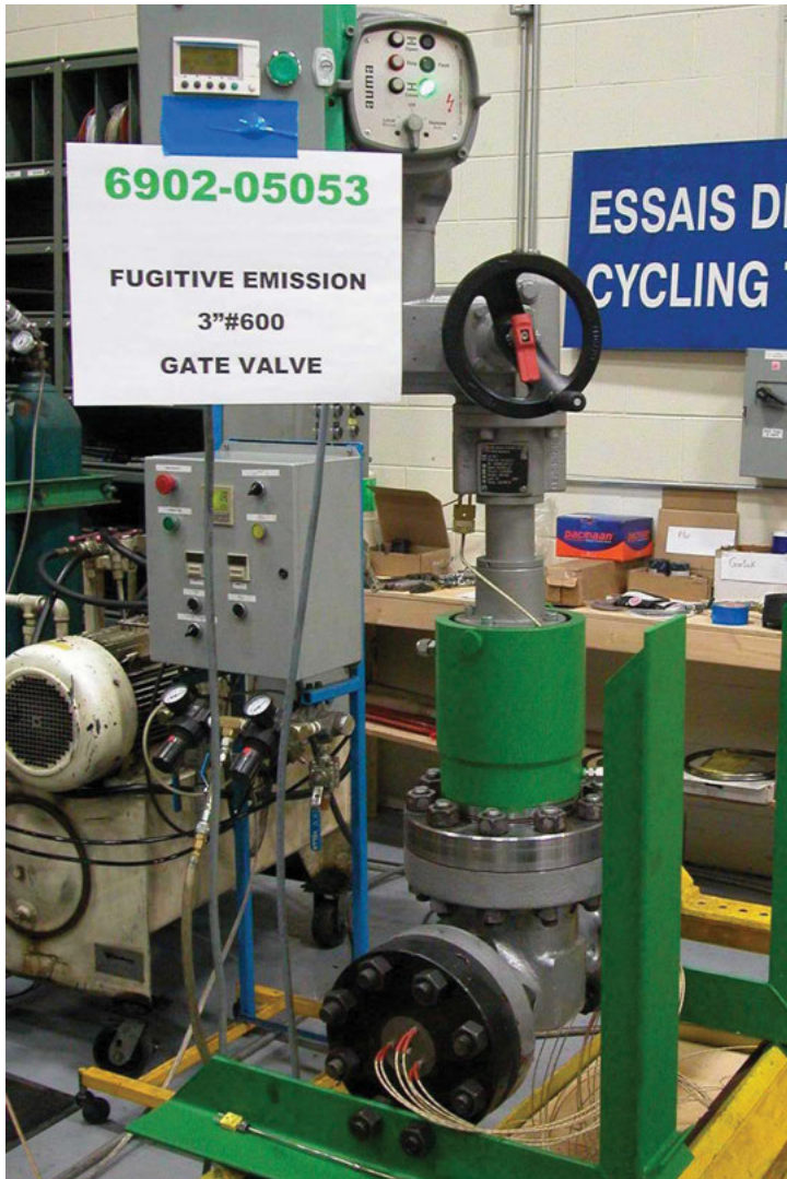
Essais R-D sur les émissions fugaces d'un robinet-vanne Velan de 3 po (80 mm), classe 600, dans le cadre du programme de qualification ISO-15848-1.
