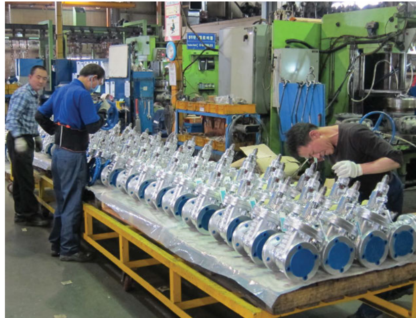
Inspection et montage des robinets-vannes.
