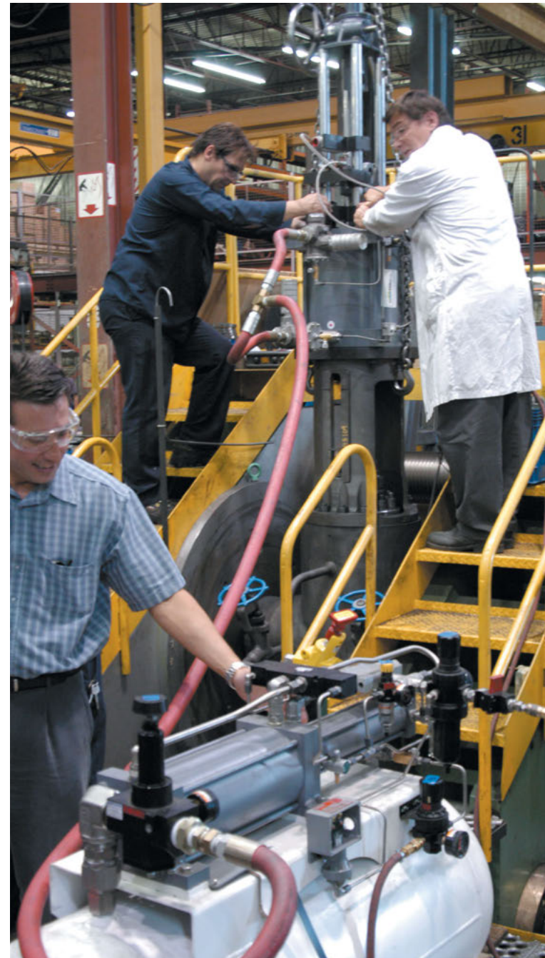
Essais R-D sur les émissions fugaces d'un robinet-vanne Velan de 3 po (80 mm), classe 600, dans le cadre du programme de qualification ISO-15848-1.
