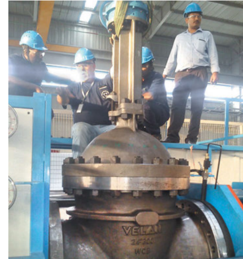
Essais de fonctionnement d'un robinet-vanne en acier moulé de 24 po (600 mm), fabriqué en Inde.
